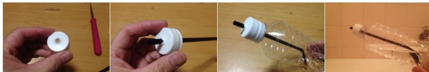
ペットボトルのキャップに、ストローの大ききびつりの穴をあけます。ストローのまっすぐのほうを穴に差し込み、曲がる方はペットボトルに入れ、キャップをしめて完成。キリを使う時はケガをしないように気をつけてください。
